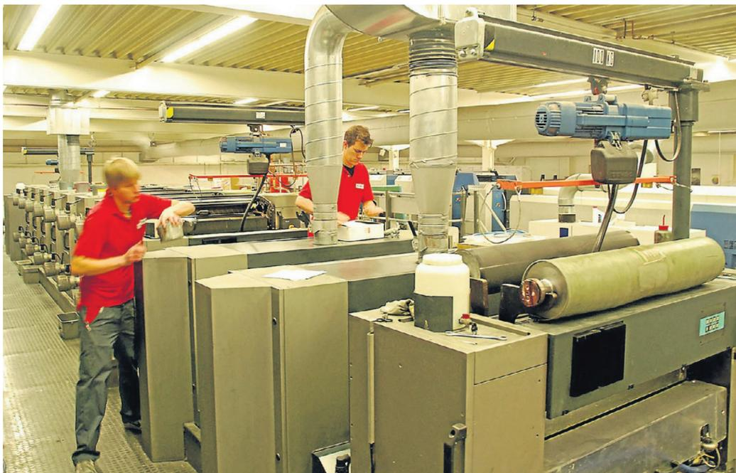
Die 14 Druckmodule der High-End Druckmaschine „Xact“ erstrecken sich über eine Länge von mehr als 20 Metern. Hier werden Musterkarten, Prospekte und Broschüren in einem einzigen Durchlauf durch Grundierungen, Speziallacke, Pigmente und Prägnungen zu hochwertigen Druckstücken veredelt. EV-Foto Beutgen
