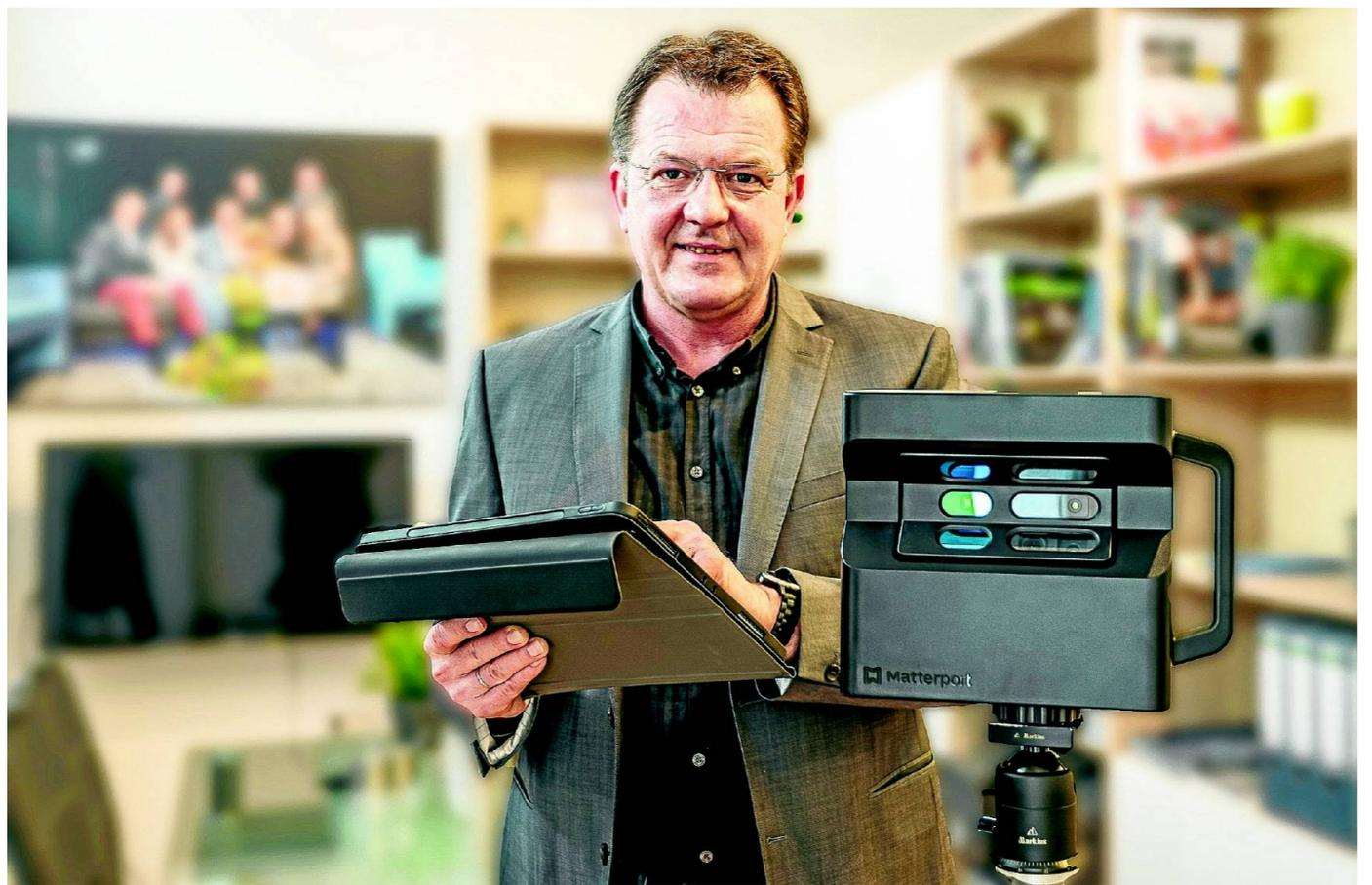
Durch die Fotografie mit dem „Matterport“ entstehen neben brillanten Fotos auch Raumdaten, die dreidimensionale Ansichten ermöglichen, die in jede Richtung dreh- und wendbar sind.
