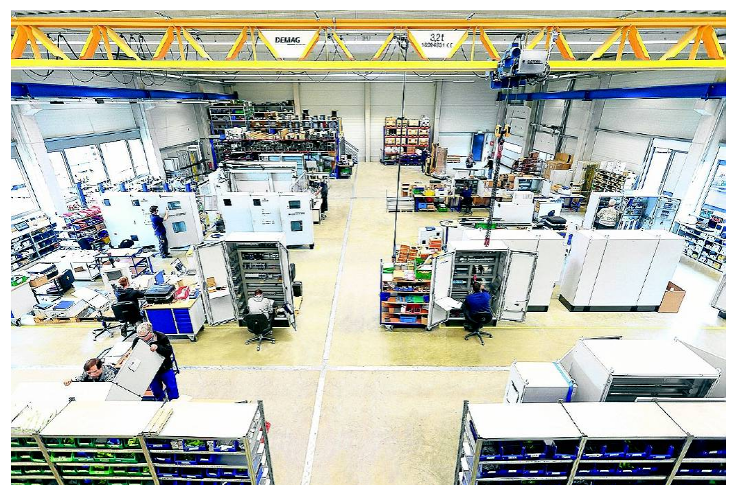
In der Montagehalle entstehen Schaltschränke. Die Firma Lammers bietet vier Produkt-Säulen an: Automatisierungstechnik, Schaltanlagenbau, Maschinen- und Betriebsdatenerfassung sowie komplette Montageanlagen.
